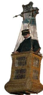
Nacelle d'observation pour train de cerf-volants Saconney
