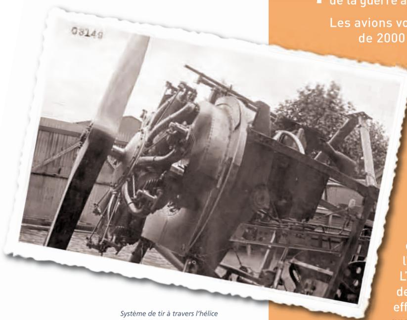
Système de tir à travers l'hélice installé sur un Nieuport XI
