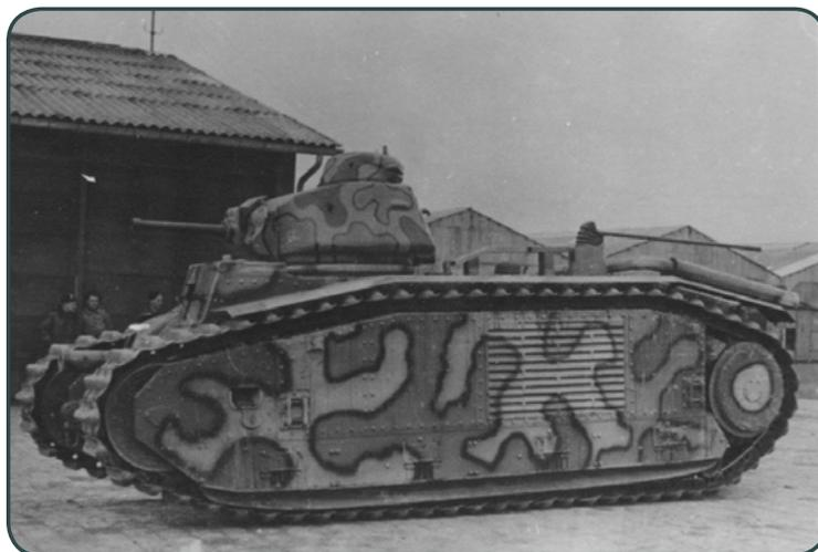
*Poids : 31,5 tonne ; longueur : 6,37 mètre - Largeur : 2,46 mètre - Hauteur : 2,79 mètre ; Equipage : 4 hommes (chef de char, pilote, tireur, radio) ; Armement : un canon de 75 millimètres modèle 1929, un canon de 47 millimètres modèle 35, deux mitrailleuses MAC 31 de 7,5 millimètres. Collection du musée des blindés.*
