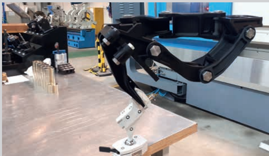
Réalisation d'un prototype (support de mitrailleuse MAG 58 pour kiosque de sous-marin nucléaire lanceur d'engins).
