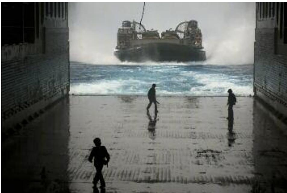
Sur le bâtiment de projection et de commandement *Tonnerre*, les marins vérifient que rien n'entrave la manœuvre pour l'entrée du Landing craft air cushioned (LCAC) dans le radier.
