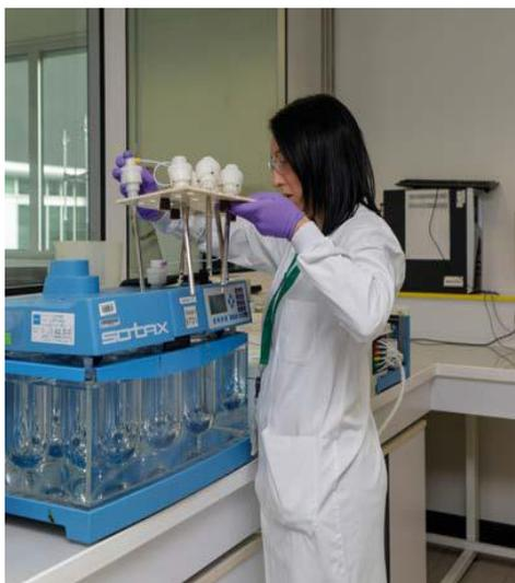
*La PCA possède des capacités de développement pharmaceutique internes. Ici, un technicien de laboratoire vérifie l'aptitude des comprimés à libérer leur substance active, en l'occurrence l'iodure de potassium.*
