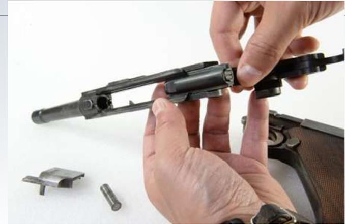
6/ Avec un tournevis plat, enfoncer le bouchon d'arrêt du ressort de percuteur et faire un quart de tour vers la gauche.
