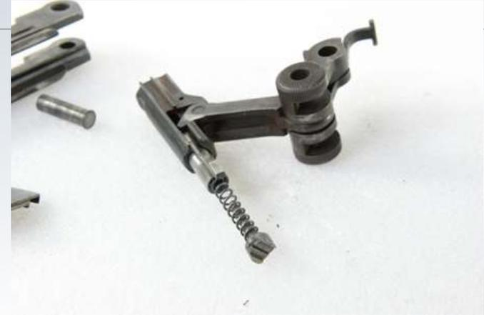
8/ Retirer le percuteur et le stocker dans un coffre-fort destiné à recevoir les pièces de sécurité.
