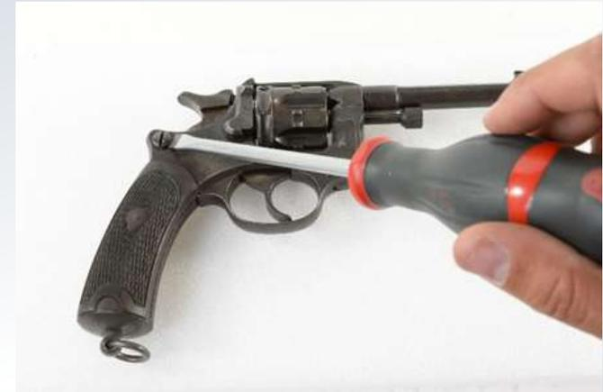
2/ Faire basculer la plaque-pontet de l'arrière vers l'avant afin d'accéder aux parties mécaniques de l'arme.
