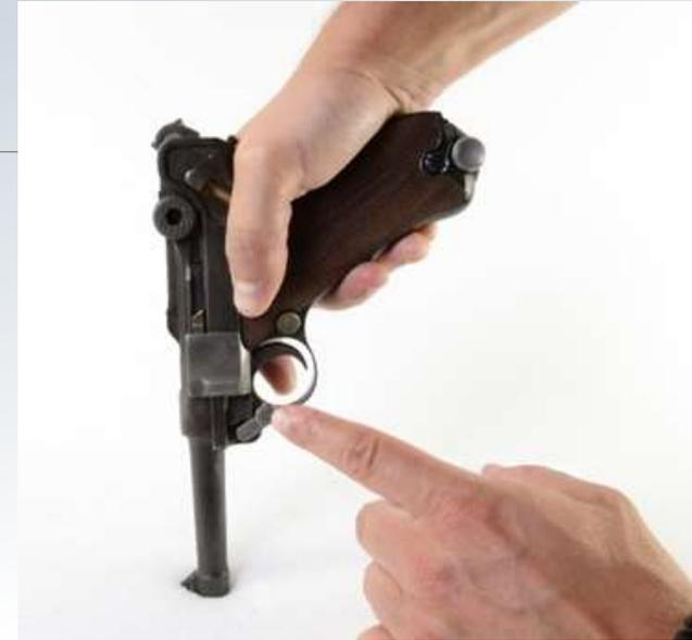
2/ Retirer ensuite la plaque de recouvrement située sur la gauche de l'arme au niveau du verrou de canon.
